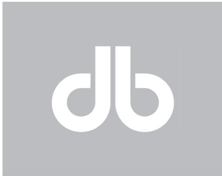
Partieller Auftrag (hier: graue Fläche, mittels Offsetdruckplatte) des matten Drip-off-Lacks (Öldrucklack)
